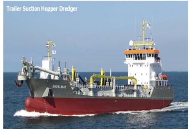
"Çekiş Emici Hazneli Tarak Gemisi" (Trailer Suction Hopper Dredger TSHD) kum, çakıl, silt veya kil gibi
