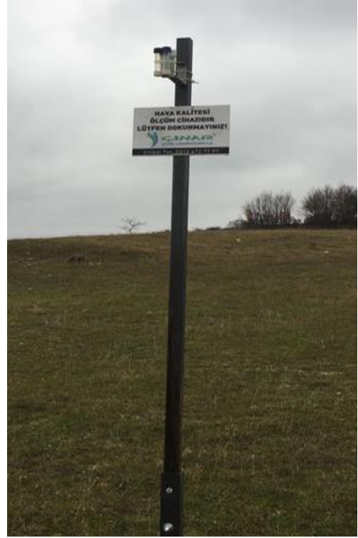
Proje alanındaki toz emisyonunun izlenmesi için kullanılan hava kalitesi ölçüm cihazı
