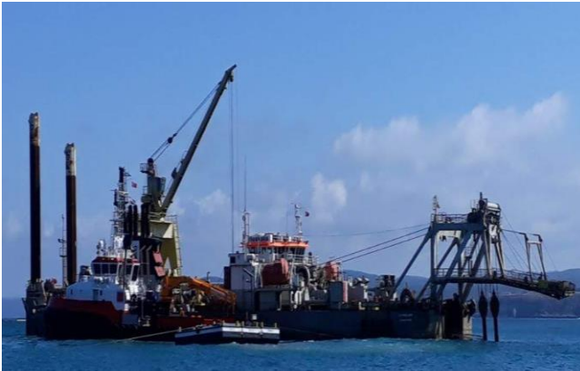
"Kesici Emici Tarak Gemisi" (Cutter Suction Dredger - CSD) kayaları kırmak (kesmek) için kesici bir döner
