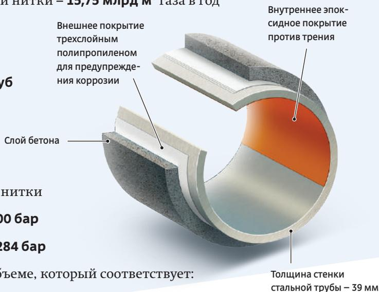
Трубы, укладываемые в прибрежных водах, покрываются слоем бетона толщиной 5–8 см для обеспечения дополнительной защиты
