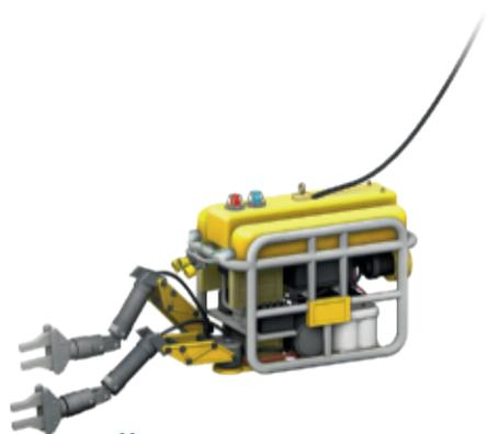
Использование подводных аппаратов с дистанционным управлением позволило наблюдать за укладкой труб на дно в ходе строительных работ в круглосуточном режиме
